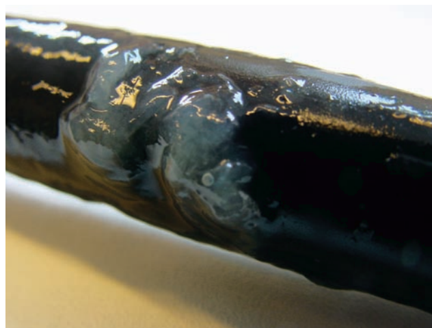
Abb. 2: Organischer Werkstoff mit starker Biofilmbildung
